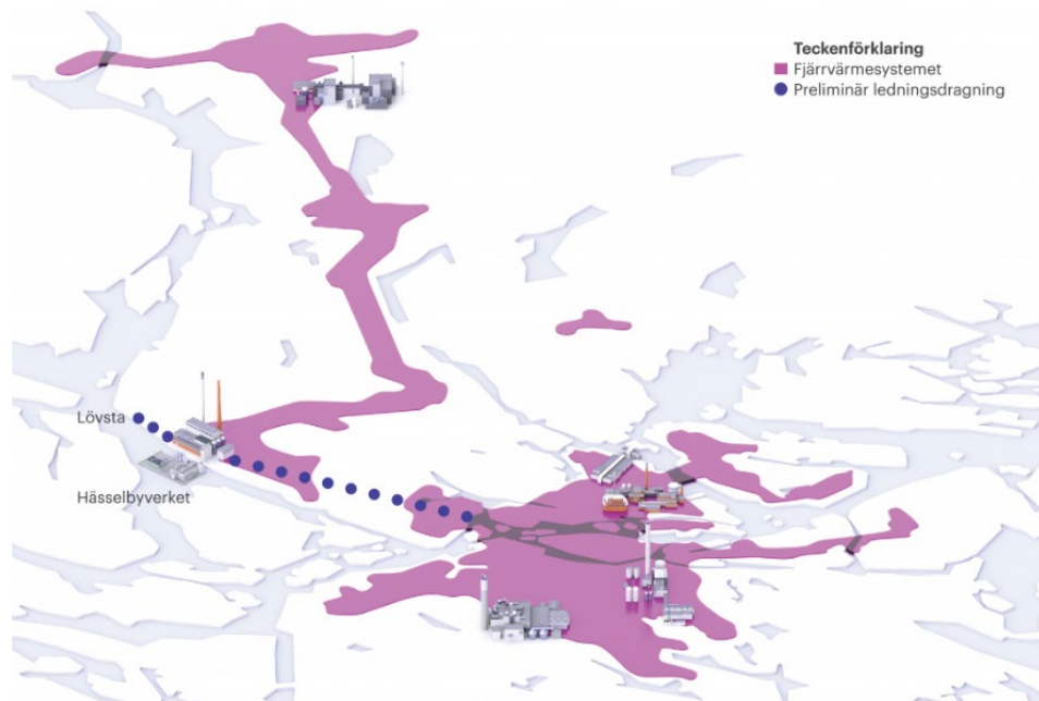
Figur 20. Karta över befintligt fjärrvärmesystem (lila, heltäckande färgning) samt den nya sammankopplingen mellan det nordvästra nätet och det centrala (blå, prickad linje) i Stockholm Exergis ägo. Ledningen förväntas bli cirka 14 kilometer lång och håller vid energistrategins författande på att utredas. Norrenergis fjärrvärmenät ligger i kommunen längs med Stockholm Exergis nya sammankopplingsledning. Källa: Stockholm Exergi.
