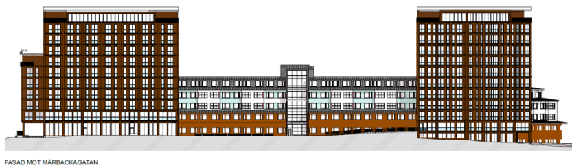
Fasadelevation över hörnhusen i elva våningar mot Mårbackagatan och länkbyggnader med påbyggnader om en våning. (Bild: S-XL Architects)
