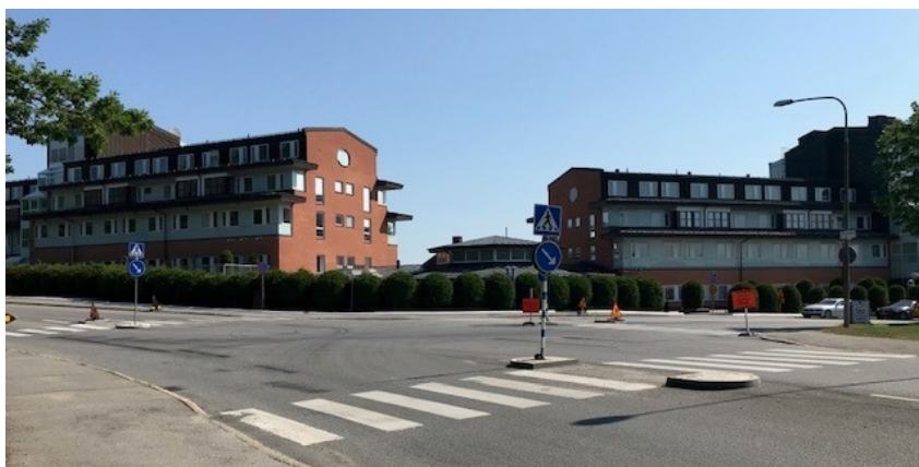
Gatuvy från Mårbackagatan mot norr. Byggnaderna är placerade med förgårdsmark mot gatorna och är uppförda i fyra våningar. I hörnen mot Mårbackagatan finns lägre entrépaviljonger i en och halv våning. Länkbyggnaderna har ett karaktäristiskt uttryck med indragna våningar i två steg, nedersta våningar och gavlar i tegel, turkosa glasfasader, burspråk med rött spröjs och svarta plåttak som täcker den översta våningen. Förgårds-
