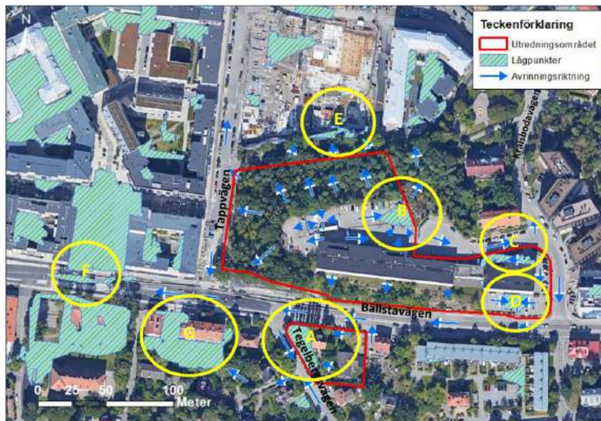
Karta från dagvattenutredningen som redovisar avrinningsriktningar och lågpunkter inom och omkring utredningsområdet. Lågpunkter som omnämns i utredningen är markerade i gult. Karta, Geosigma, 2022.
