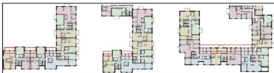
Markering av rum mot tyst sida i lägenheter som överskrider 60 dbA ekvivalent ljudnivå, kv Enigheten, Källa Akustikkonsulten.
