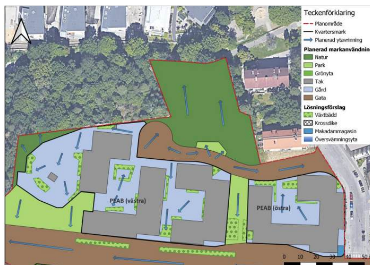
Redovisning av föreslagna dagvattenlösningar inom Delområde 1, Enigheten, Rejlers 2023
