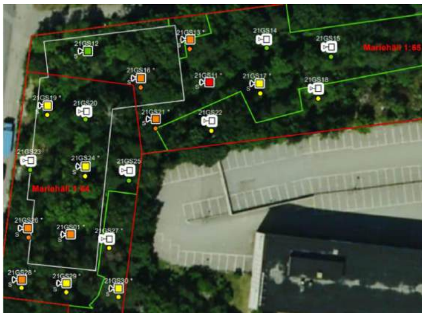
Påträffade föroreningar över generella riktvärden KM (gul), MKM (orange) eller Farligt avfall (röd). Källa Geosigma
