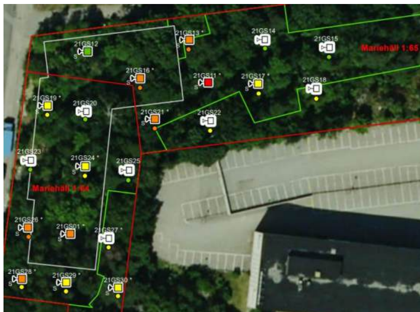
Påträffade föroreningar över generella riktvärden KM (gul), MKM (orange) eller Farligt avfall (röd), Geosigma
