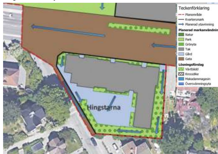
Redovisning av föreslagna dagvattenlösningar inom Delområde 2, Hingstarna, Rejlers 2023
