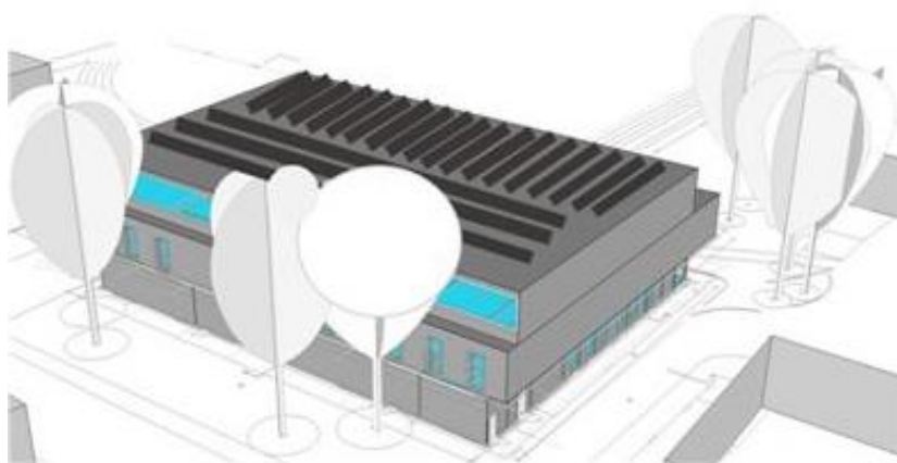
Solceller på taket till Västbergahallen
