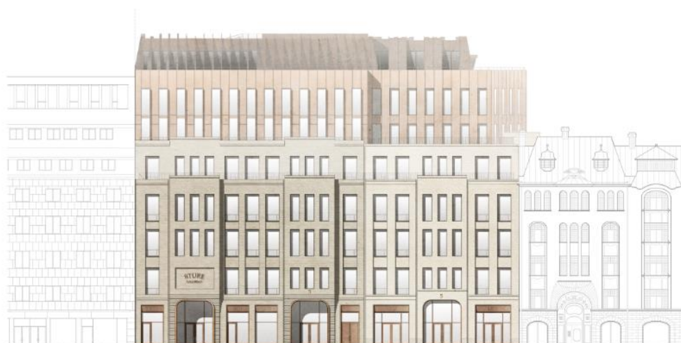
Fasaden för den nya byggnaden på Grev Turegatan 3-5 delas upp likt två byggnader för att ansluta till gatans småskaliga karaktär.
