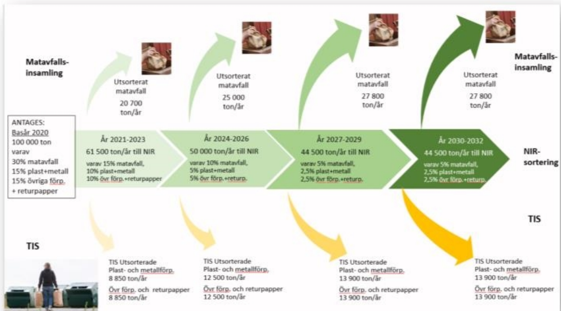
Figur 2 Illustration över mängden utsorterat matavfall samt förpackningar som inte behöver gå till NIR-anläggningen under planperioden.
