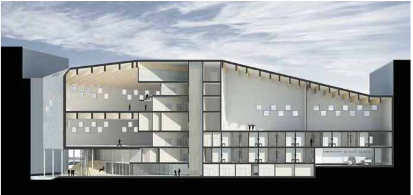
Sektion genom byggnaden som visar relationen mellan idrottshallarna. Skala 1:600
