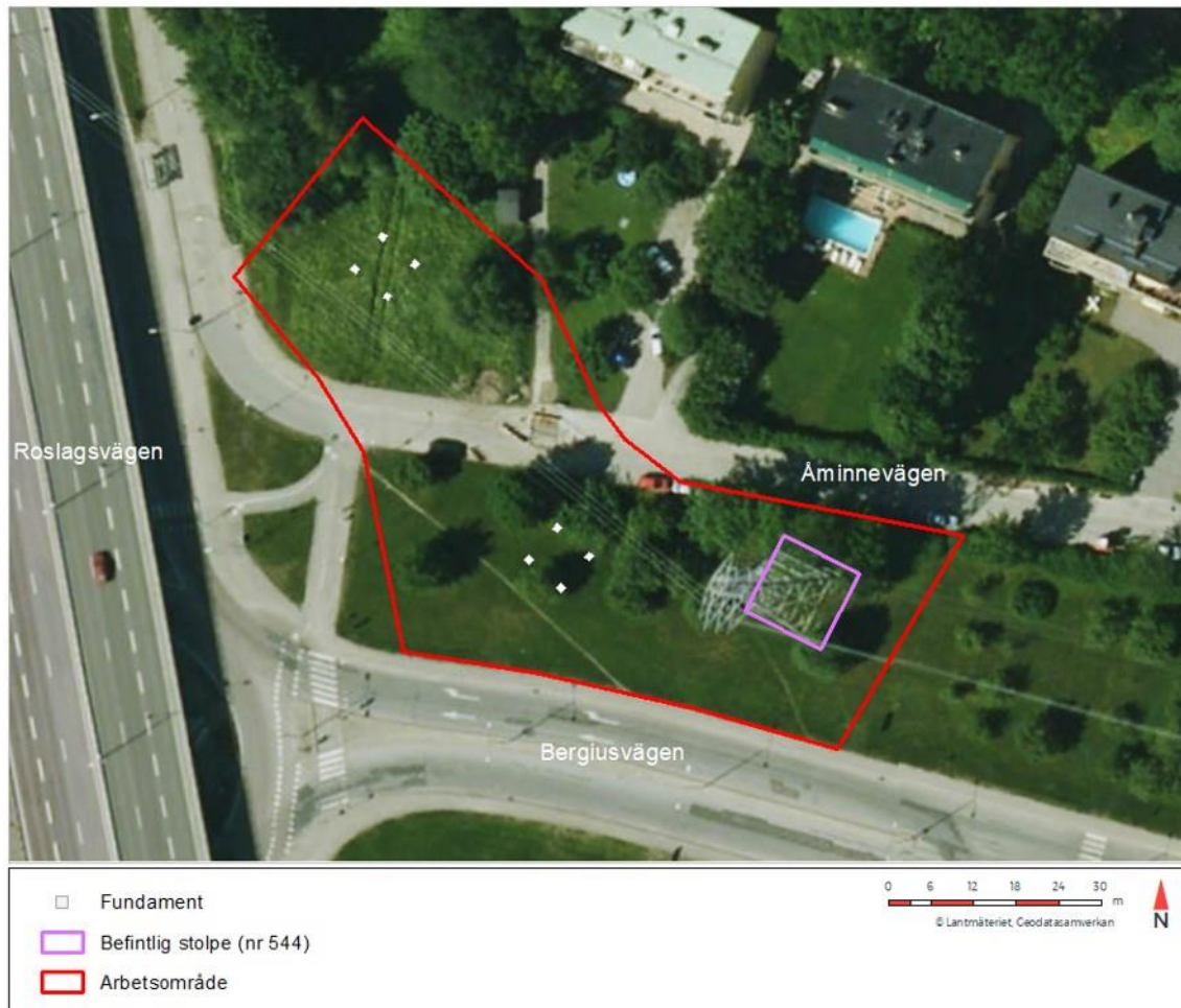
Figur 4. Planerat arbetsområde för montering och uppsättning av kabeländstolpar i Ekhagen, samt placering av stolpfundament.
