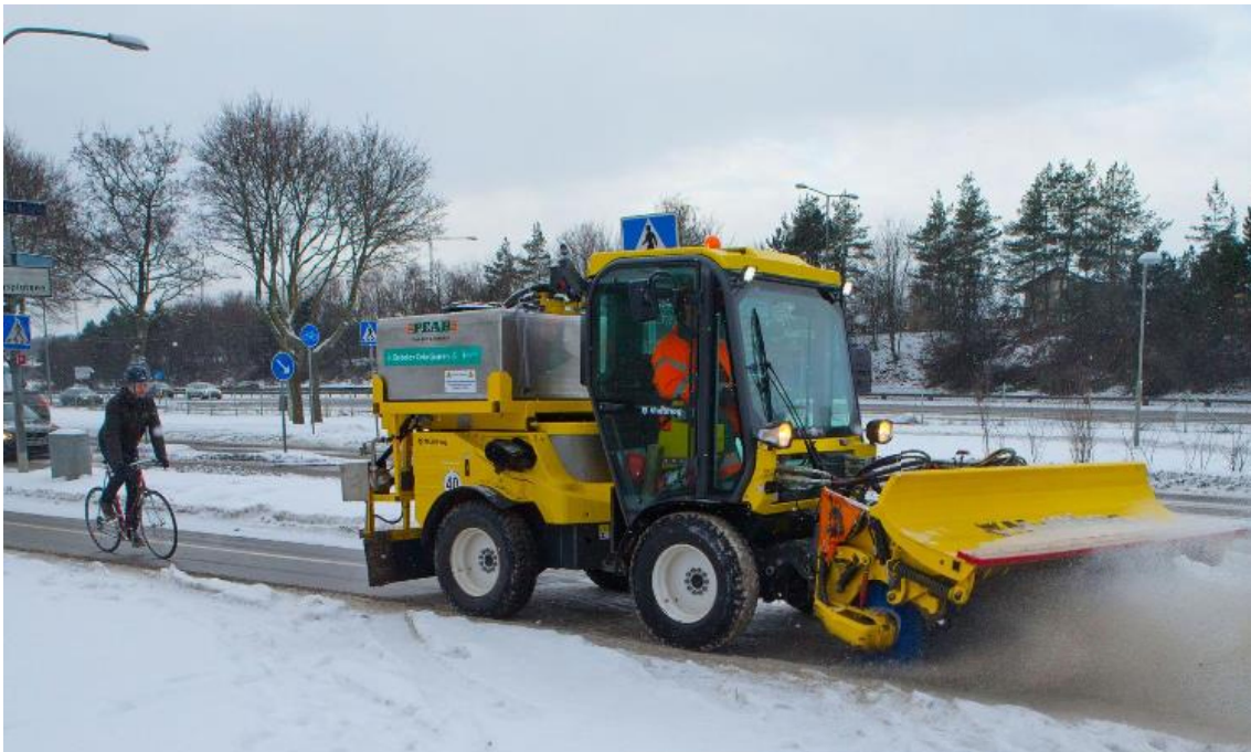
Figur 3.3 Sopsaltning av gång- och cykelväg.
