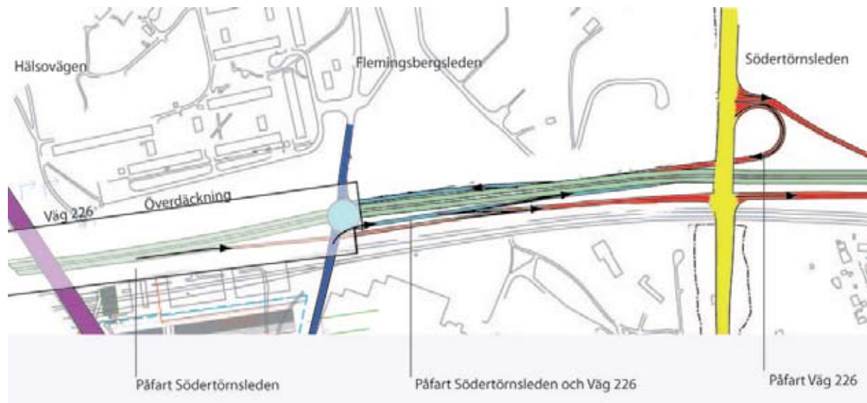
Ramplösning mellan Södertörnsleden och överdäckningen.
