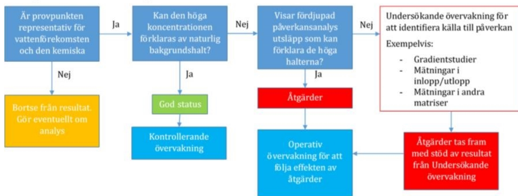
Figur 3 Strategin för undersökande övervakning när orsaken till att en vattenförekomst inte når en miljö kvalitetsnorm är okänd. Flödesdiagrammet visar de olika val och utredningar som till exempel en länsstyrelse behöver gå igenom innan de kan starta undersökande övervakning.
