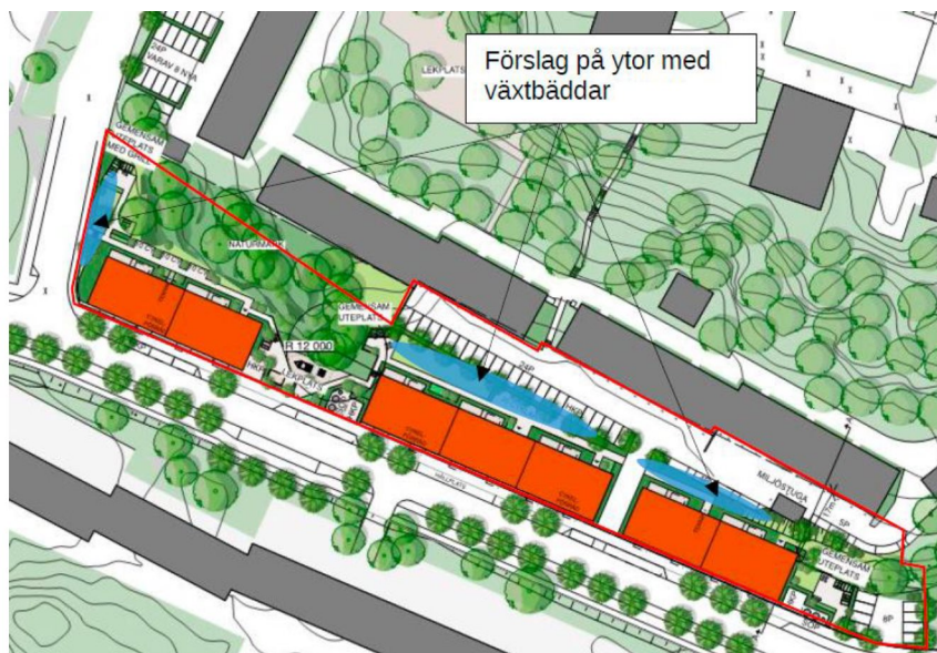
Figur som visar föreslagna ytor för dagvattenhantering i kv Hammarö. (Bjerkning) Föreslagna ytor är i detaljplanen reglerade som mark som inte får bebyggas.
