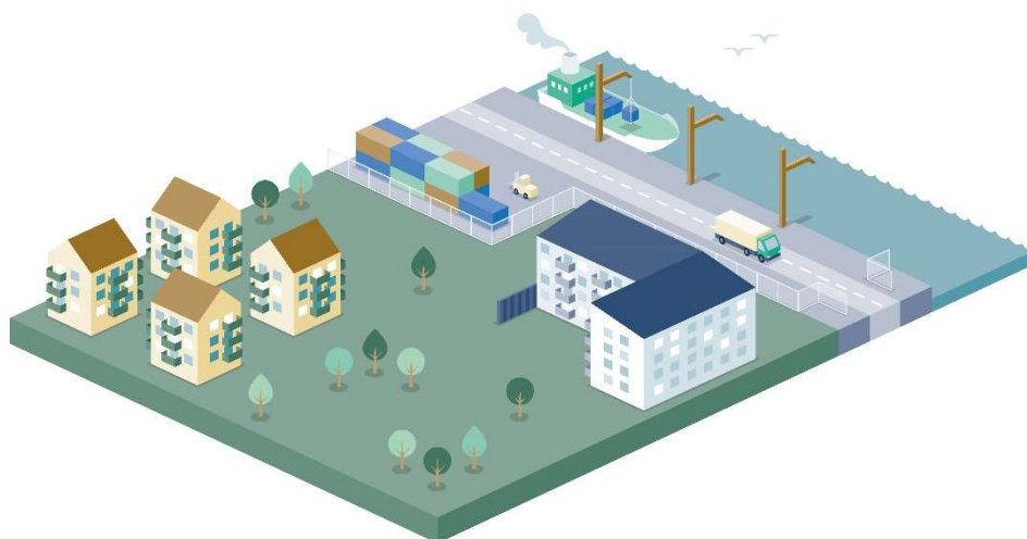
Figur 3. Hamn med ny och äldre bebyggelse i närheten. Den nya bebyggelsen till höger är bulleranpassad och lägenheterna har tillgång till en bullerskyddad sida. Därför kan högre ljudnivåer accepteras vid den nya bebyggelsen jämfört med vid den äldre bebyggelsen till vänster.
