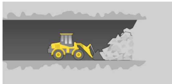
Steg 4: Massorna efter det sprängda berget schaktas undan och transporteras ut ur tunneln. Bergytan förstärks vid behov med sprutbetong och bultar.
