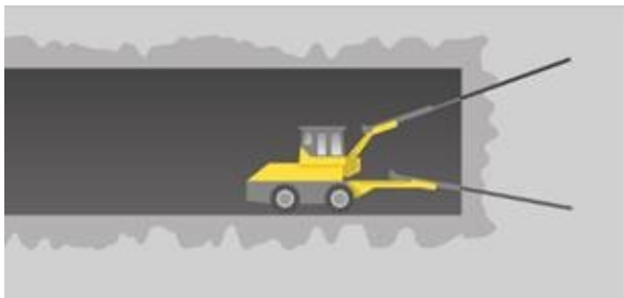
Steg 1: Förinjektering, 15-20 meter långa hål borraras runt den blivande tunneln.
