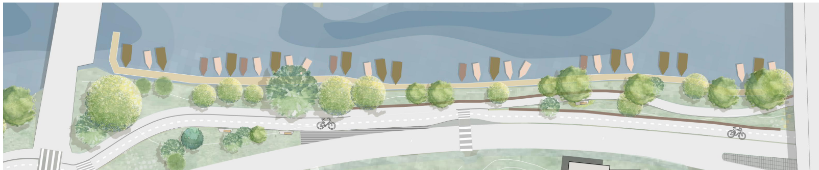
Illustrationsplan över Långholmsvägen till Västerbron. Gång- och cykelväg separeras med en stödmur vid övergångsstället.
