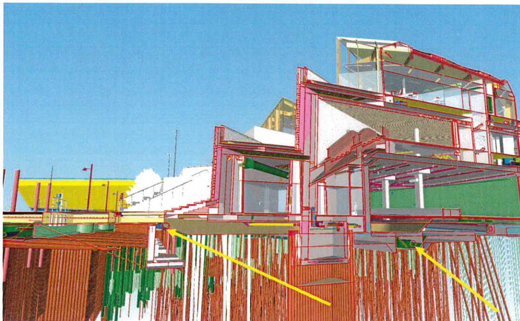
Bild 5: Sektion från väst, under 2D-fastigheten Södre Torn 1. Ledning under trappa (område 2) samt ledning under gata (område 6) markerats med gula pilar.
