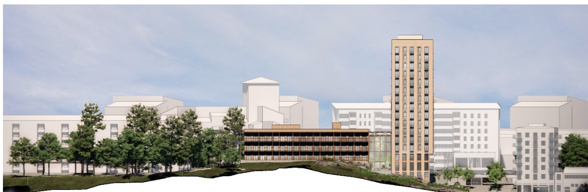
Fasad mot sydväst som visar kopplingen mellan gångfartsområdet och naturkullen samt byggnadens tre delar: lamellen, den uppglasade länken och högdelen. Bild: Belatchew Arkitekter.
