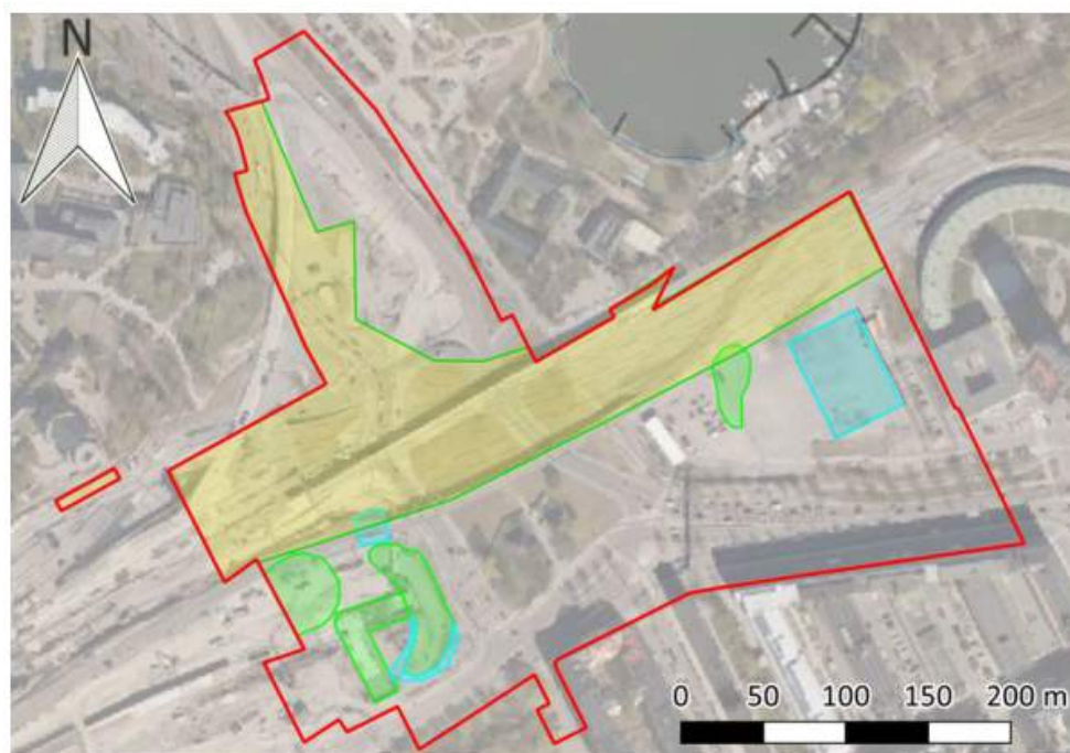
Områden som är färgfyllda är utgrävda, sanerade eller delvis sanerade. Gul och grön fyllning visar sanerade områden och blått delvis sanerade områden. (Liljemark Consulting, 2022).
