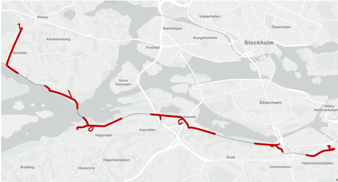
Figur 8 Kartbild över avloppstunnelns sträckning. Utsprängda delar markerade.
