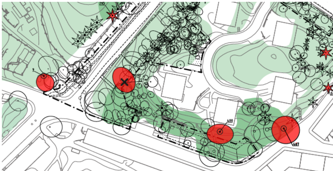
Karta som redovisar särskilt skyddsvärda träd inom och i anslutning till planområdet. Träd markerat med svart kryss inom delområde A är träd som kommer att behöva avverkas vid ett genomförande av planförslaget. Bild: SBK
