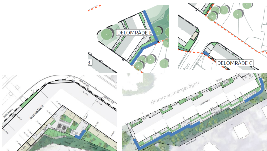
Principskiss redovisande planerat läge för stödmur (blå heldragen linje) inom delområde B, C, E och F som tillåts vara högre än 1,2 meter. Bild: Arkitema med bearbetning av SBK.
