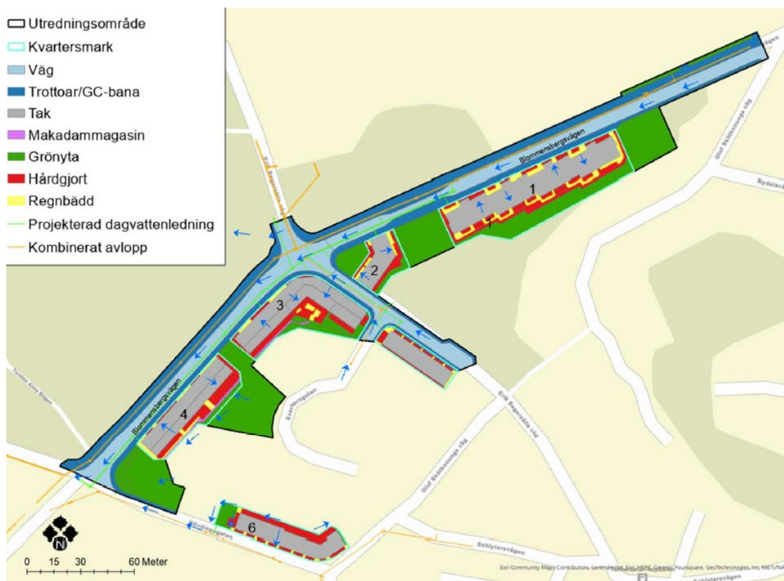
Karta redovisande föreslagen dagvattenhantering inom kvartersmark. Bild: Norconsult
