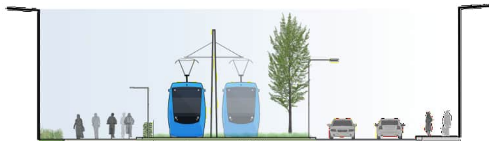
Figur 7. Principsektion för spårväg i reserverat utrymme, sidoförlagd.
