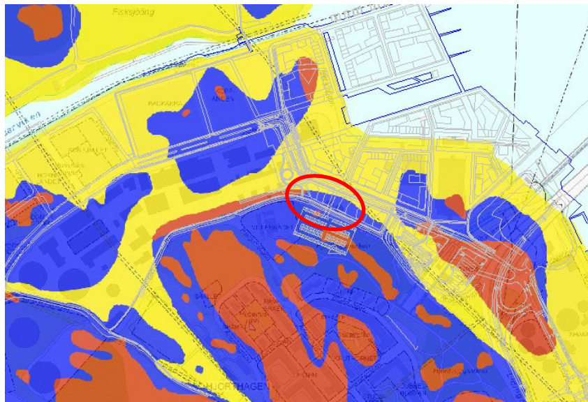
Kolkajen - Ropsten, Stadens byggnadsgeologiska karta. Gult visar lera, blått visar moränjord, rött visar berg vid eller nära markytan. Planområdet är inringat med rött.
