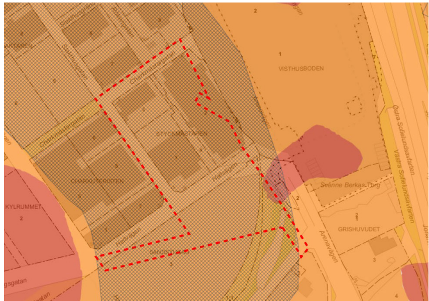
Byggnadsgeologisk karta. Röd färg avser berg i dagen, orange färg avser växellagring, grön färg avser sten, sand och grus och rutnät avser fyllning. Bild: Stockholm stads byggnadsgeologiska karta.
