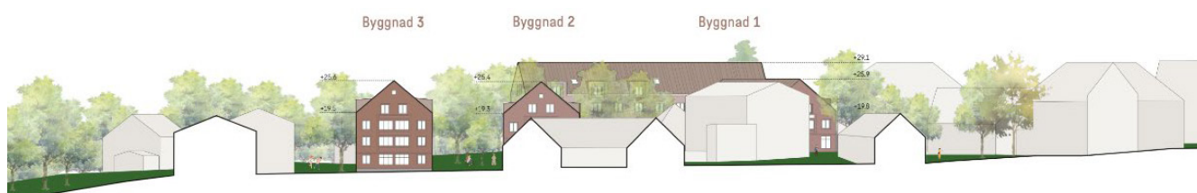
Sektion A-A' genom byggnad 1 och 2 samt fasad på byggnad 1 och gårdsmiljö. Nockhöjden på den nya bebyggelsen möter upp befintlig bebyggelses nockhöjd på andra sidan huvudstråket. Byggnad 2 trappas ner i höjd och understryker den sluttande terrängen. Bild: Sweco
