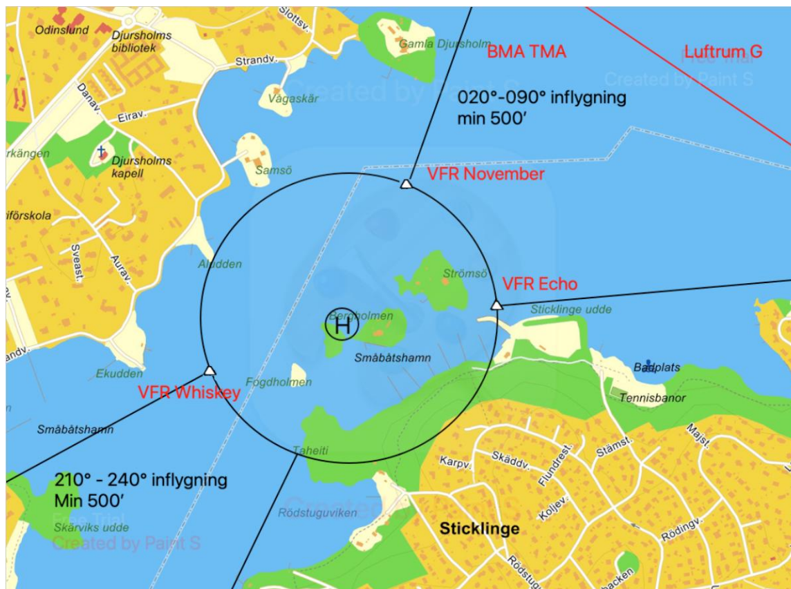
Figur 1. Karta med landningsplats, kontrollzon och inflygningsvägar.
