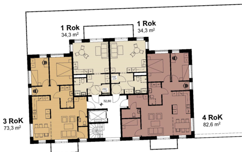
Exempel på utformning av planlösningar vid korsningen Smedshagsvägen/Mäster Karls väg. Två lägenheter kan placeras med fasad mot bullkällan med hälften av bostadsrummen mot tyst sida.
