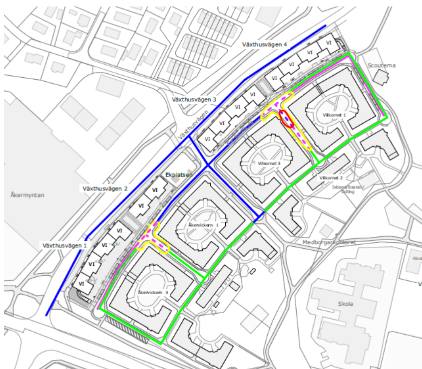
Redovisning av räddningsvägar vid skyfall för Karl Bondes väg. Gröna vägar kan användas av räddningstjänsten för att passera lågpunkter.
