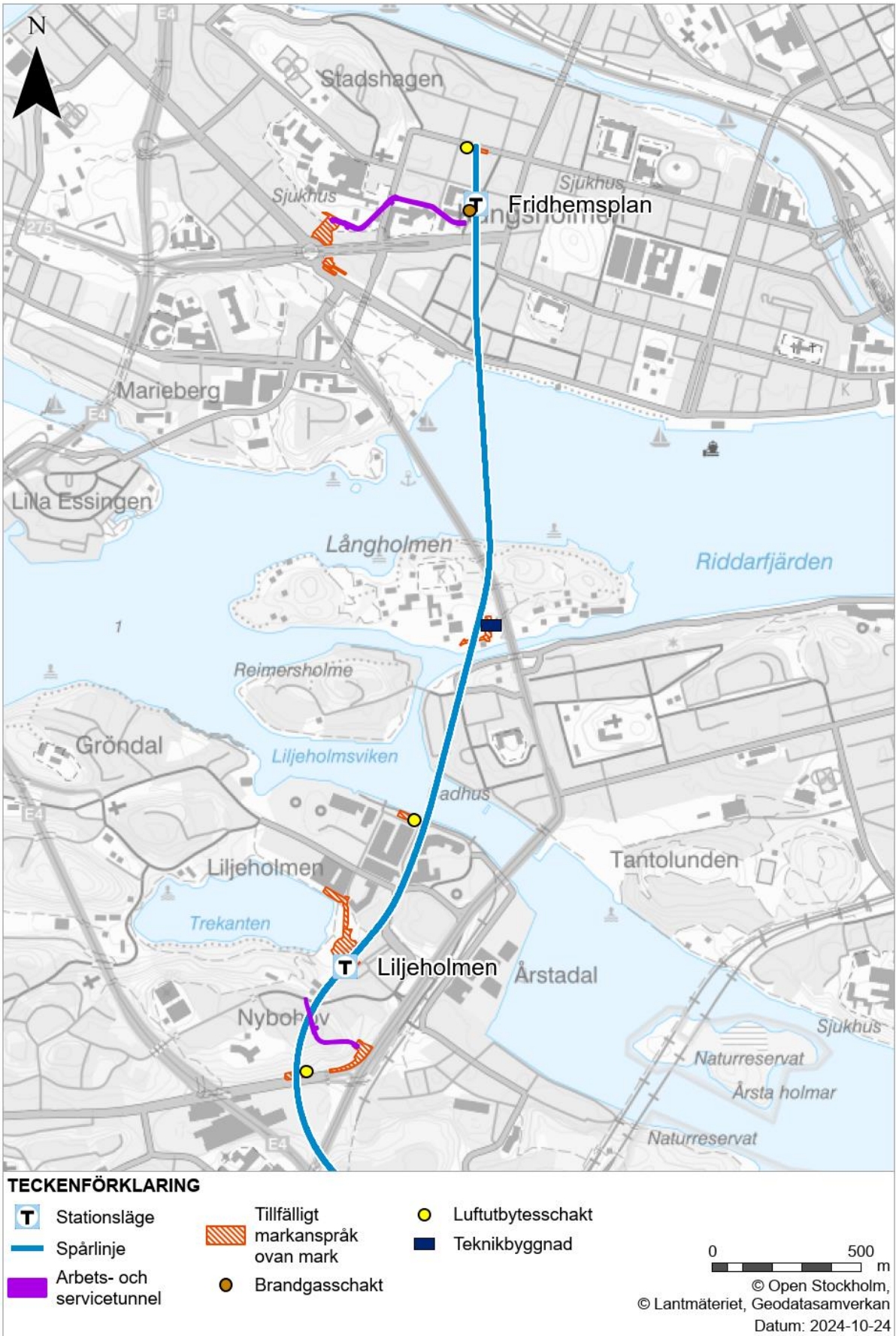
Figur 9. Planerad dragning av spårlinjen, planerad lokalisering av stationsentréer, luftutbytes- och brandgasschakt, teknikbyggnad ovan mark, arbetstunnlar, alternativ för arbets- och servicetunnel vid Fridhemsplan samt tillfälliga markanspråk ovan mark för utbyggnad av tunnelbana till Älvsjö, norra delen av sträckan.
