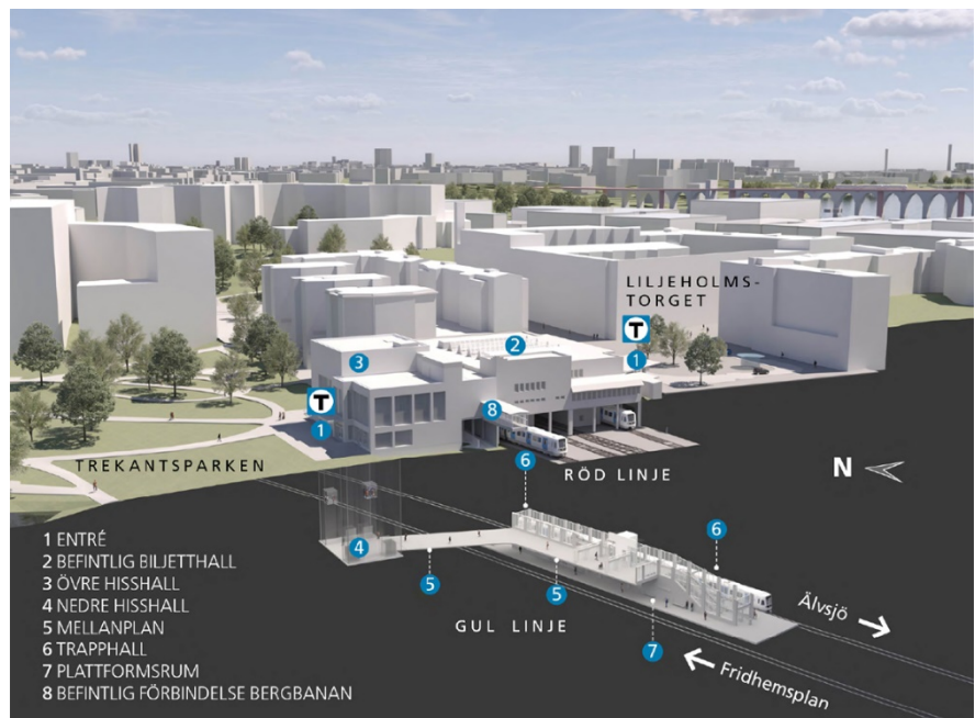
Illustration av station Liljeholmen som visar den utbyggda anläggningens utformning och ny entré i Trekantsparken. Källa:FUT
