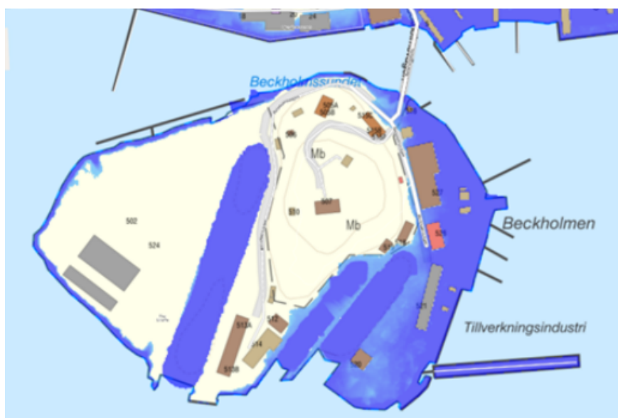
Landområden inom detaljplanen som ligger under den rekommenderade lägsta grundläggningsnivå på + 2,7 meter enligt RH2000 markerade med blått. Källa: Sweco.
