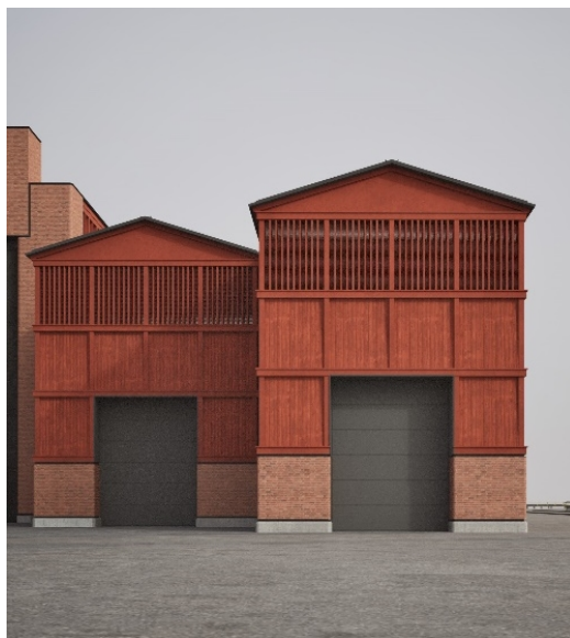
Verkstadshallarnas gavlar är uppdelade i syfte att skapa dynamik i volymspelet och ta ned byggnadernas skala. Fasad mot söder.
