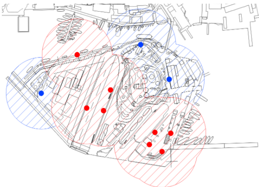
Illustrationen redovisar befintliga brandposter (blå) samt förslag på placering av nya brandposter (röd). Skraffering visar 75 meters avstånd från brandpost. Källa: Sweco
