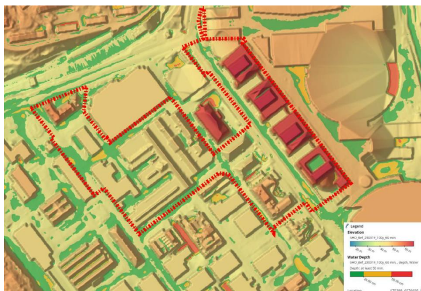
Nulägesmodellering: Beräknade maximalt vattendjup vid ett klimatkorrigerat 100-årsregn. Gröna ytor har max 20 cm vatten, gula ytor mellan 20 och 50 cm. Bild: Sweco. Planområdets utbredning har efter granskningen justerats. Illustrationen visar den tidigare gränsen.
