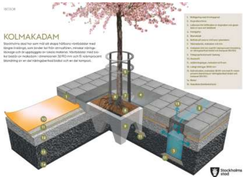
Figur 3: Sprängskissen som visar principen för växtbädd enligt Stockholmsmodellen.
