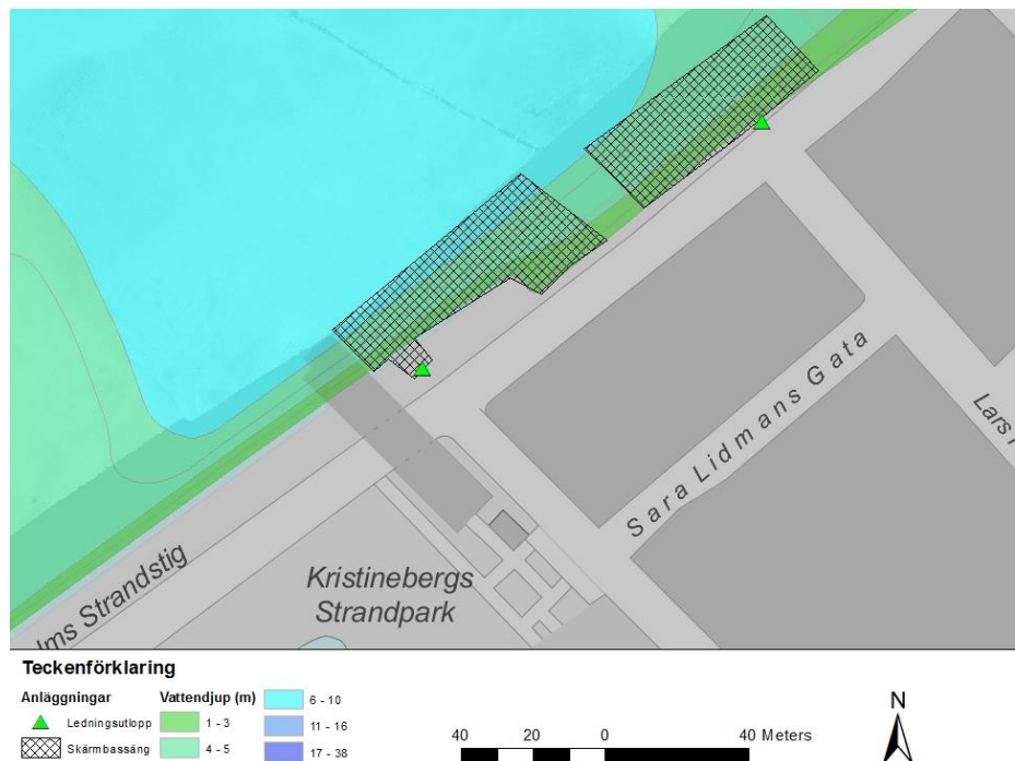
Figur 2. Ungefärlig placering av föreslagna skärbassäng och befintliga utlopp. Utrymme har lämnats för kylledning.
