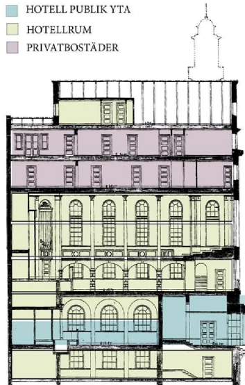
Längdsektion - Ny Användning (Överlagrad på bygglov från 1926)
