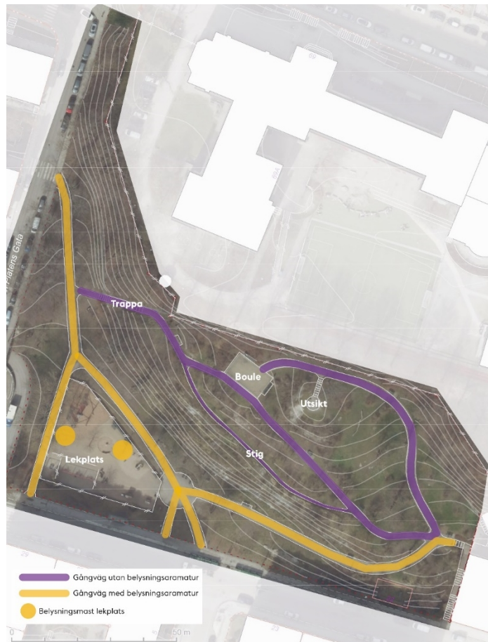
Figur 1 - Ortofotograf över Pontonjärparken med gångvägar markerade. Här redovisas vilka stråk i parken som har (gul linje), och som saknar (lila linje), belysningsarmatur.
