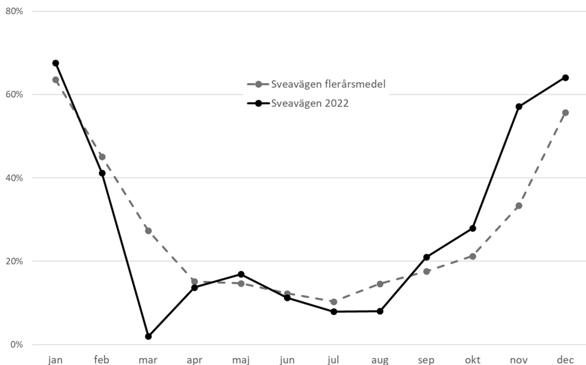
Figur 17. Uppmätta månadsmedelvärden för antal timmar med fuktig vägbana på Sveavägen år 2022 samt jämförelse med flerårsmedelvärdet 2014–2021.
