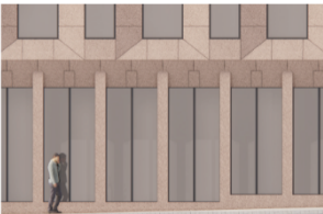
Illustration: Planförslagets utformning av bottenvåningen mot Malmskillnadsgatan med varannan pelare demonterad, en jämn fönsterindelning i relation till pelarnas placering samt markeringar i fasaden som visar tidigare pelarlägen. (Tengbom arkitektkontor)
