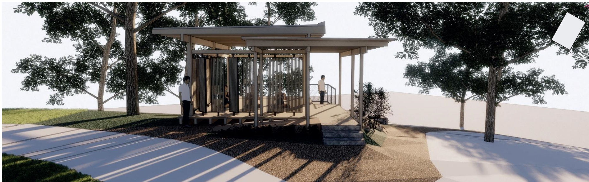
Vy från nordost. Här möter paviljongen det befintliga parkstråket (asfalt). En stenmjölsyta och en smal plantering framför paviljongen fyller utrymmet mellan gångväg och entré.
