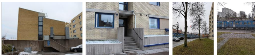
Trappa och mur/räcke i formgjuten betong. Växtbädd och stödmurar i betong vid entré. Gräsmatta mot nordost, med kantsten av betong, 10 st askar och en plattsatt uteplats.
