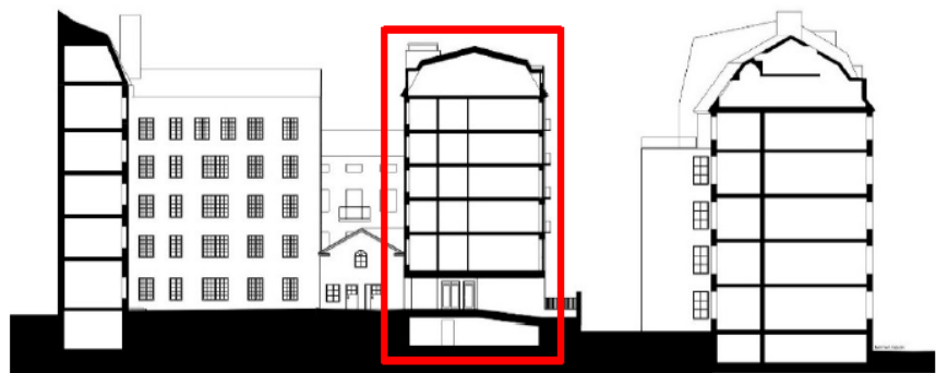
Sektion genom ny byggnad och gårdsbebyggelse, gatubyggnad. Kommendörsgatan till höger i bild. Tillkommande volym markerad med röd ruta. Bild: Lugnet Arkitektur.
