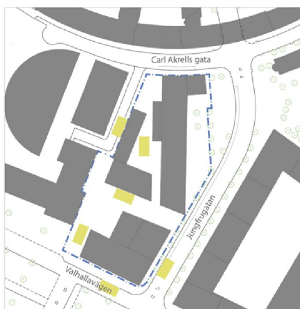
Uppställningsplatser för utryckningsfordon.
