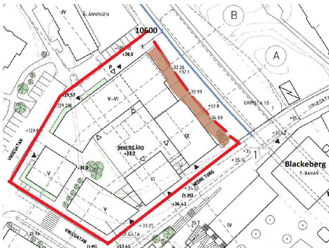
Figur 1.1. Nya bostäder och vårdcentral är planerat inom fastighetsgränsen (röd), (från DinellJohansson, 2018-01-24). Mot tunnelbanan (blå) planeras jord- och bergschakt (brun). Från utsida hus till centrumlinje spår är det ca 10.6 m.
