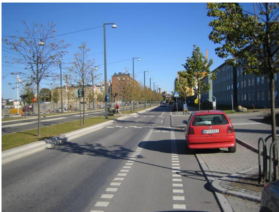
Figur 26. Träden till höger, som växer i skelettjord och får dagvatten, har gröna blad jämfört med de träd som växer till vänster där det inte är skelettjord.
