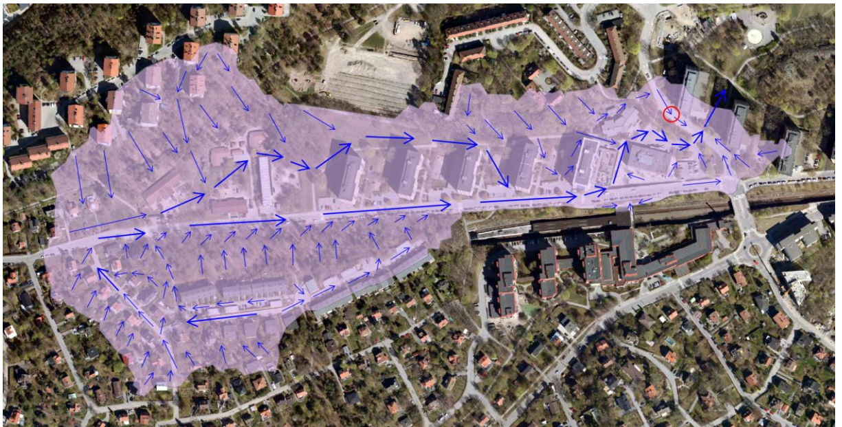
Figur 20. Avrinningsområde (lila markering) och ytliga avrinningsvägar (blå pilar) för dagvatten vid större skyfall. Lågpunkt i området är markerad med röd ring. Notera att dagvattnet rinner vidare ut ur området i nordöst. Bilden är baserad på information från skyfallsmodelleringsverktyget Scalgo och visar situationen vid ett cirka 10 mm-regn.
