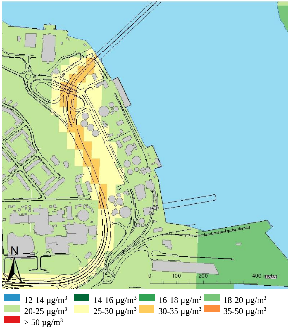
Figur 11. Beräknad dygnsmedelhalt av partiklar, PM10, ( \mu\text{g}/\text{m}^3 ) under det 36:e värsta dygnet för nollalternativet år 2030. Normvärdet som ska klaras är 50 \mu\text{g}/\text{m}^3 .
