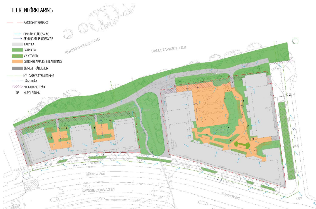
Systemlösning dagvattenhantering Masugnen 5 och 7. WSP.
