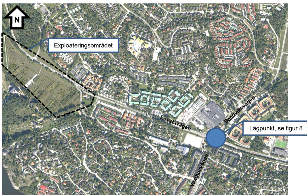
Figur 7. Översvämningsytor som fungerar som fördröjningsvolym vid kraftiga regn vid korsningen Löfstavägen / Växthusvägen (Sandviksvägen)
