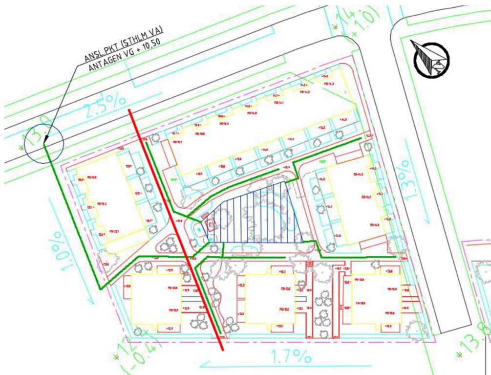
Figur 27. Föreslagen dagvattenhantering för kvarter 9. Dagvattenmagasin i blått på kvarter 9 innergård. Gröna linjer visar dagvattenledningar. Röd linje visar projekterad spillvattenledning.
