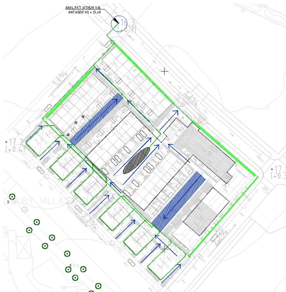
Figur 23. Föreslagen dagvattenlösning för kvarter 5. Ljusgrönt markerar yta som tas om hand i växtbäddar. Blå markerar yta för underjordiska/nedsänkta dagvattenmagasin. Svartskrafferaden område visar nedsänkt yta. Svart streckad linje visar utbredning av underjordiskt garage.
