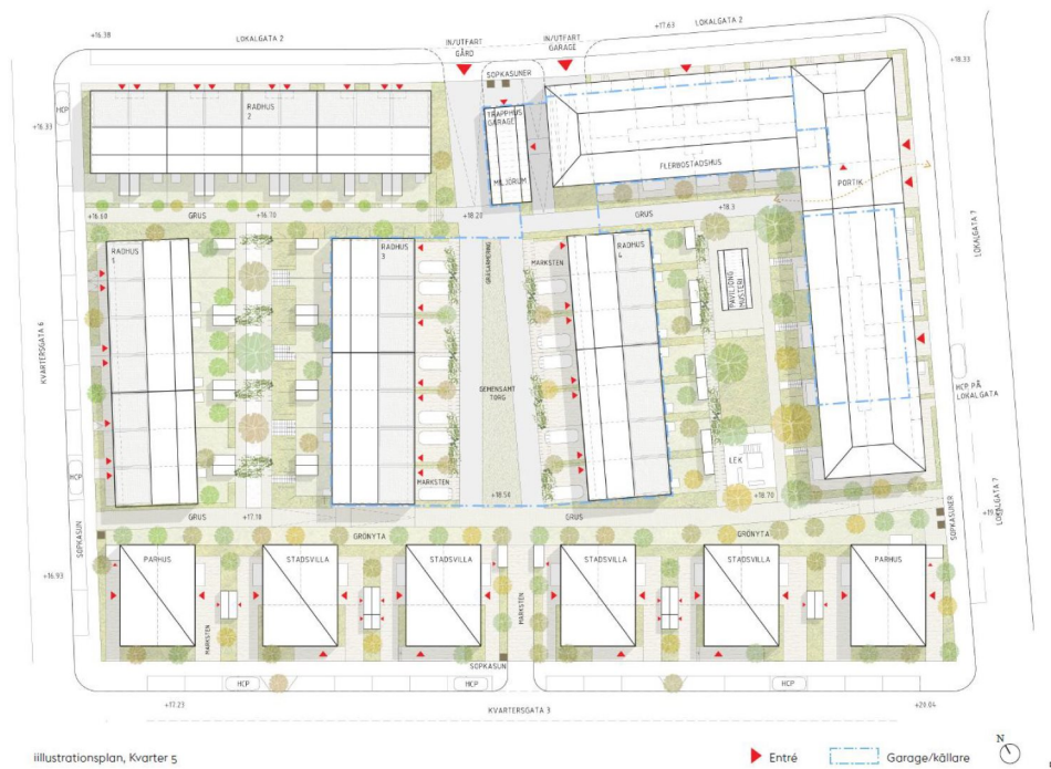
Figur 9. Kvarter 5, situationsplan (erhållen 2018-09-07). Ljusblå, streckad linje visar det underjordiska garagets placering.
