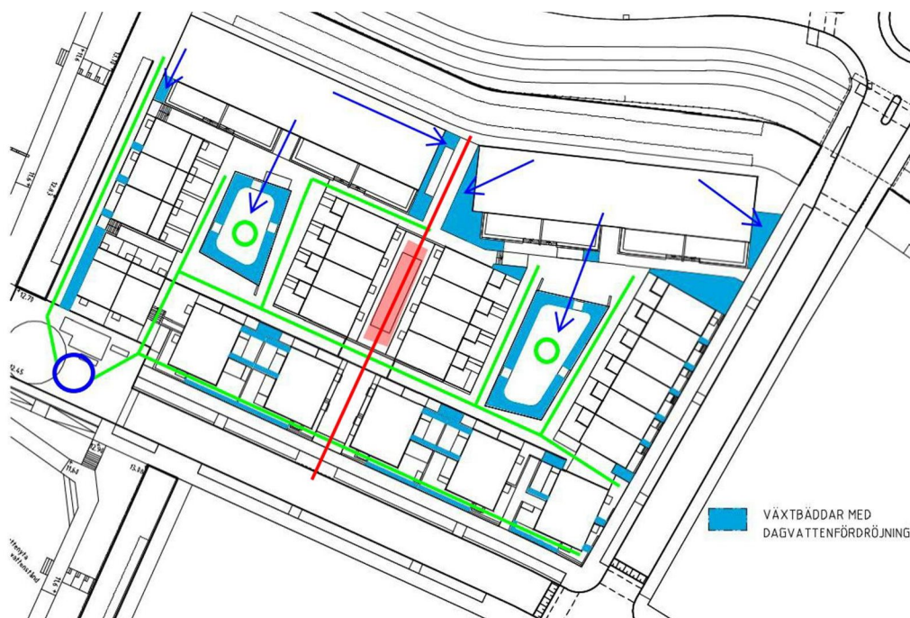
Figur 26. Föreslagen dagvattenhantering. Gröna ringar visar plats för underjordiska magasin. Gröna streck visar ledningar. Blå ring visar anslutningspunkt. Rött område visar plats för nedsänkt yta. Röd linje visar projekterad spillvattenledning.
