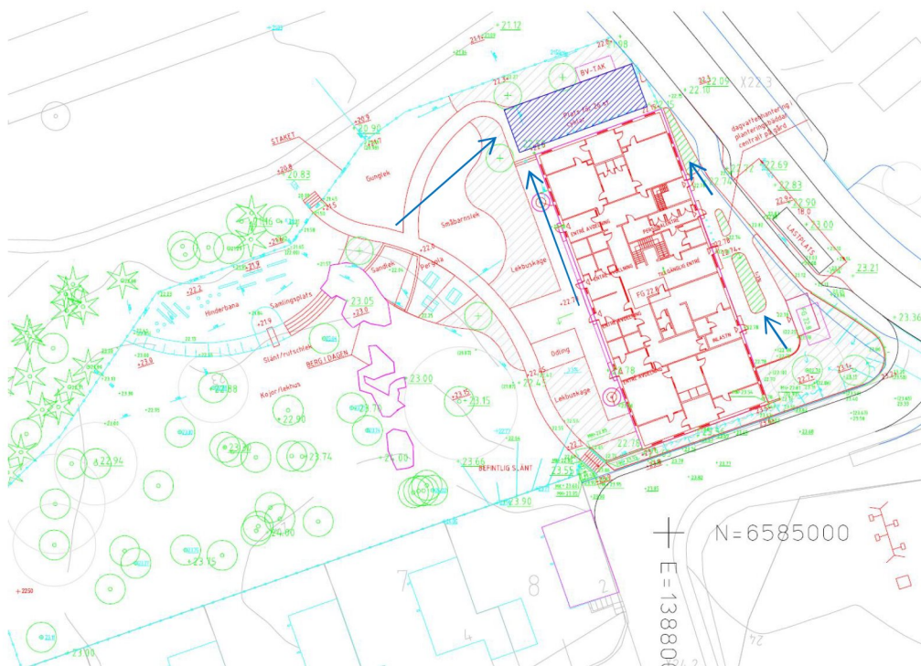
Figur 28. Föreslagen dagvattenhantering för kvarter 10. Dagvattenmagasin visas i blått och växtbäddar i grön skraffering.
