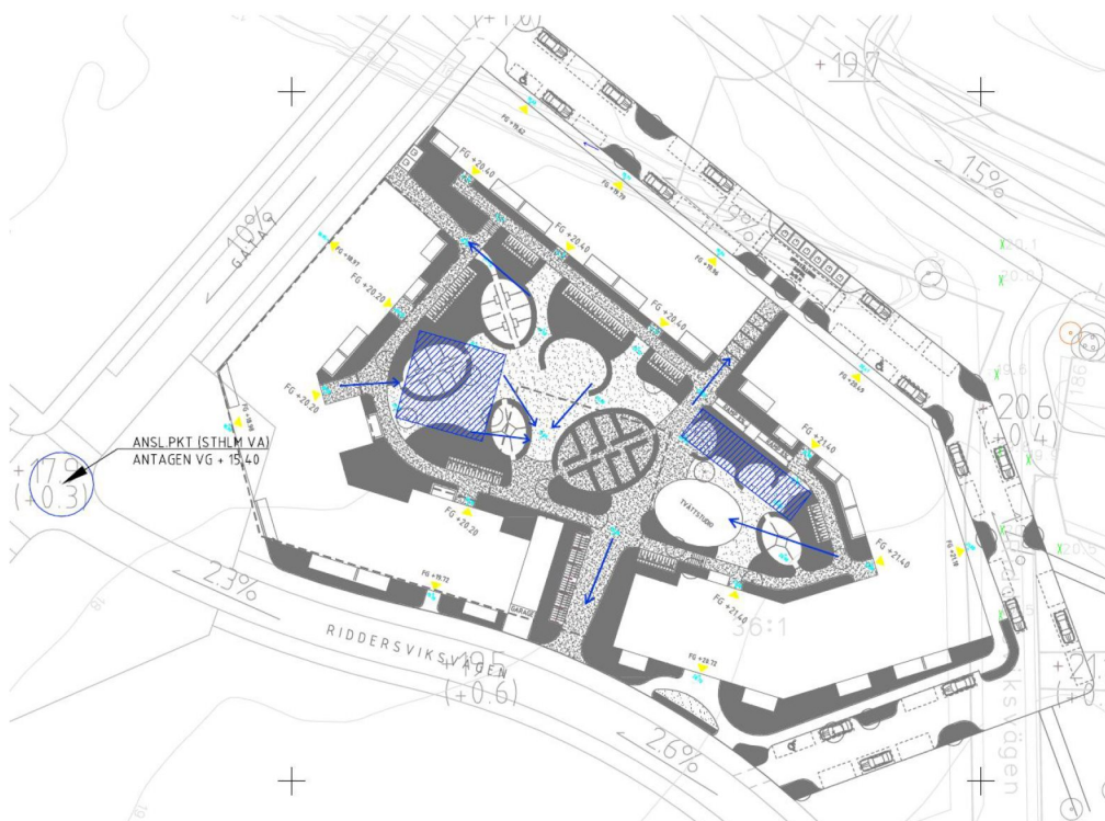
Figur 21. Föreslagen dagvattenlösning för kvarter 2. Gråstreckad linje visar det underliggande garagets utbredning. De blå ytorna visar plats för underjordiska magasin. De blå pilarna visar riktning för givna höjder.
