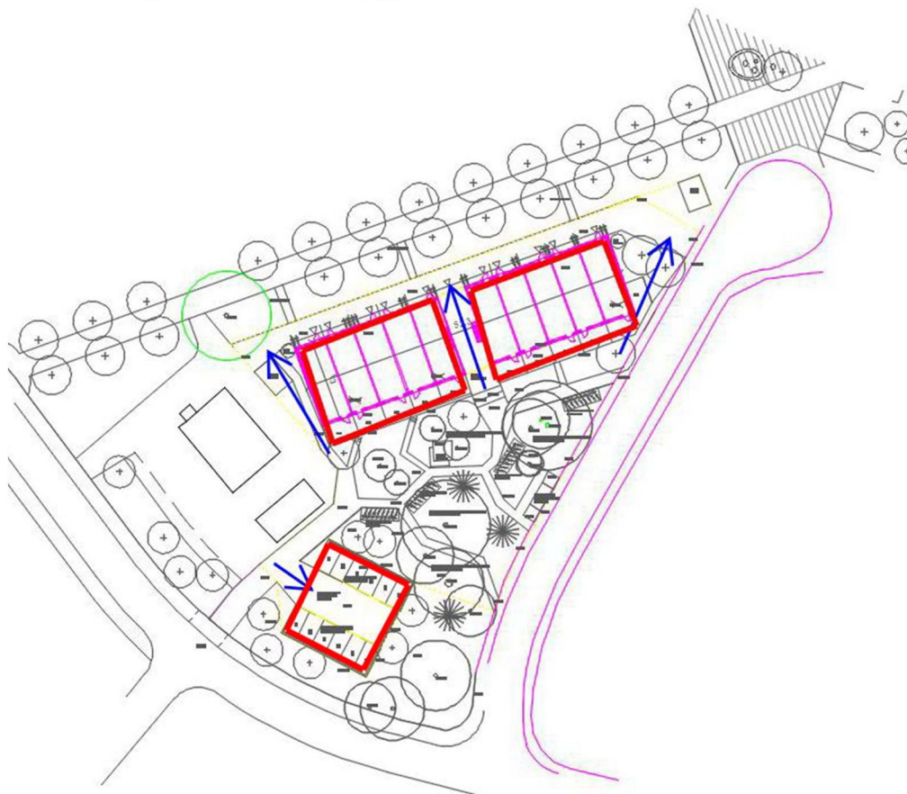
Figur 34. Skyfallsvägar inom kvarter 1. Blå pilar visar vattenets rinnvägar. De röda linjerna visar instängda lågpunkter.
