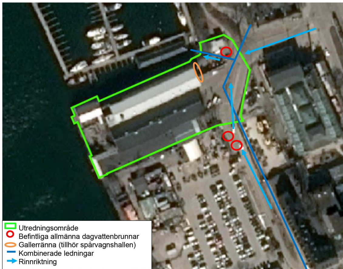
Figur 5. Vy över utredningsområdet i nuläge med rinnriktning, allmänna kombinerade ledningar samt befintliga brunnar. Information hämtad från Samlingskarta med tillval, Stockholms stad, daterad 2016-06-10.
