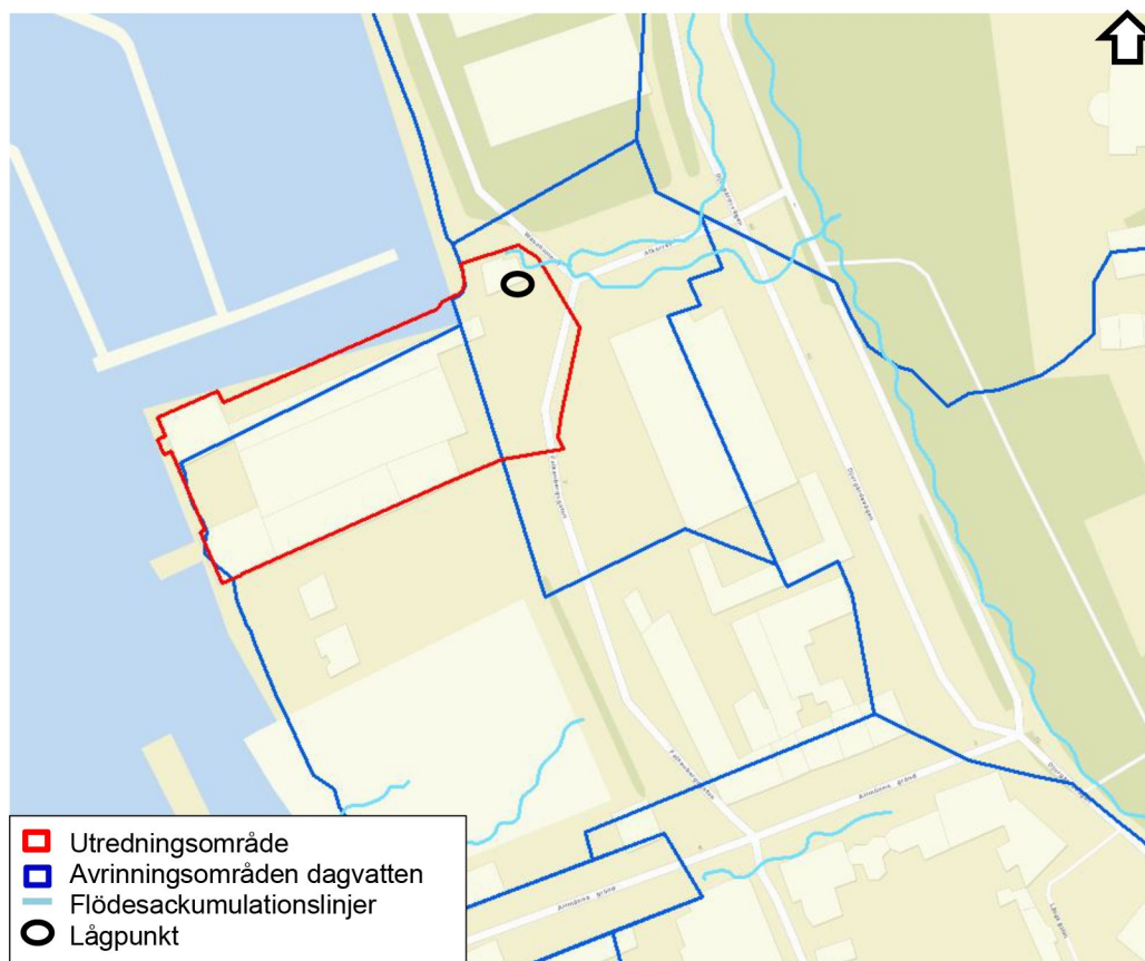
Figur 4. Avrinningsområden dagvatten 3 samt flödesackumulationslinjer vid skyfall 4 .
