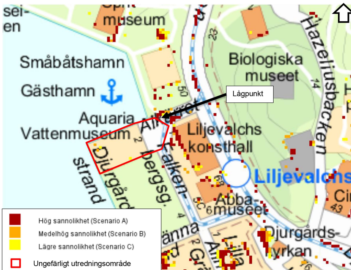
Figur 7. Sannolikhet för marköversvämning vid 100-årsregn enligt Stockholms Vattens skyfallsmodellering 2015.
