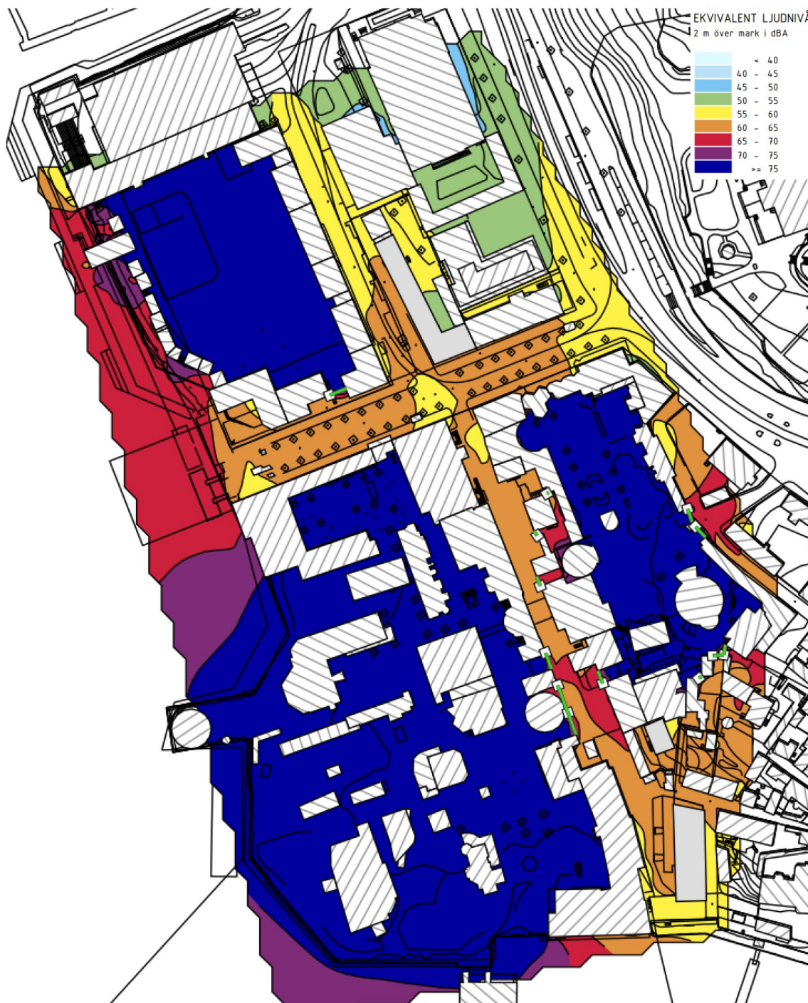
Figur 14. Scenario 1, bullerkarta redovisande ekvivalent ljudnivå då parkeringsplatsen är utbyggd och nöjesverksamheten är öppen. De bullerutsatta bostäderna markeras som gråa byggnader.
