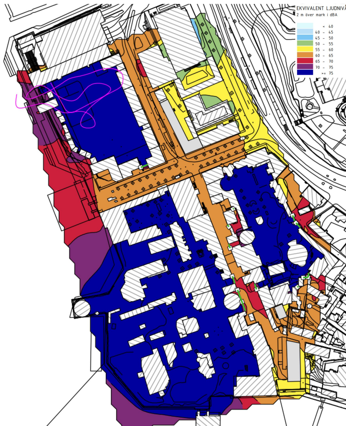
Figur 17. Scenario (3): Bullerkarta redovisande ekvivalent ljudnivå då verksamheten är öppen. Inklusive exempel på en 60 meter hög berg- och dalbana och bilbana på befintlig parkeringsplats. Berg- och dalbana i form av linjekälla (se rosa linjer). Mest bullerutsatta bostäder markeras som gråa byggnader.
