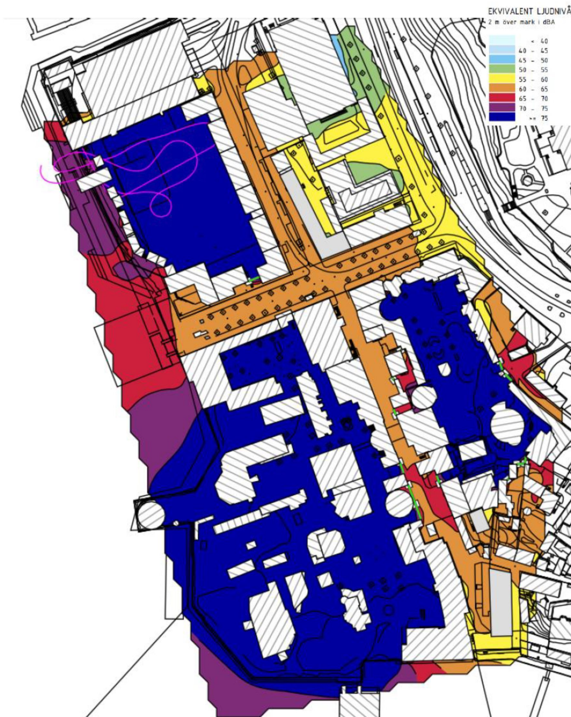
Figur 16. Scenario (2): Bullerkarta redovisande ekvivalent ljudnivå då verksamheten är öppen. Inklusive exempel på en 40 meter hög berg- och dalbana och bilbana på befintlig parkeringsplats. Berg- och dalbana i form av linjekälla (se rosa linjer). Mest bullerutsatta bostäder markeras som gråa byggnader.
