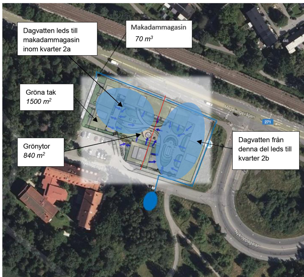
Figur 15. Rening och fördröjning i makadammmagasin (blåa linjer markerar dagvattenledningarnas sträckning och blå pilar visar vattnets riktning). Grönmarkerade takytor avser sedumtak.
