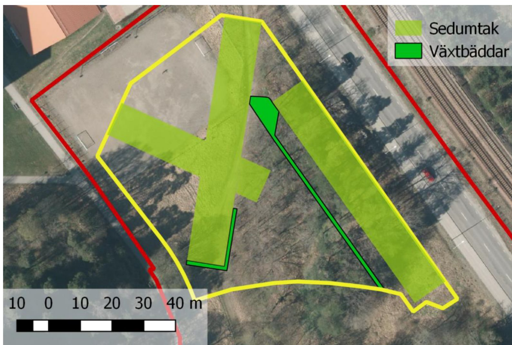
Figur 9. Fördröjningsförslagen för dagvattenåtgärder bygger på gröna sedumtak och växtbäddar. Växtbäddarnas totala area motsvarar ca 130 m 2 .
